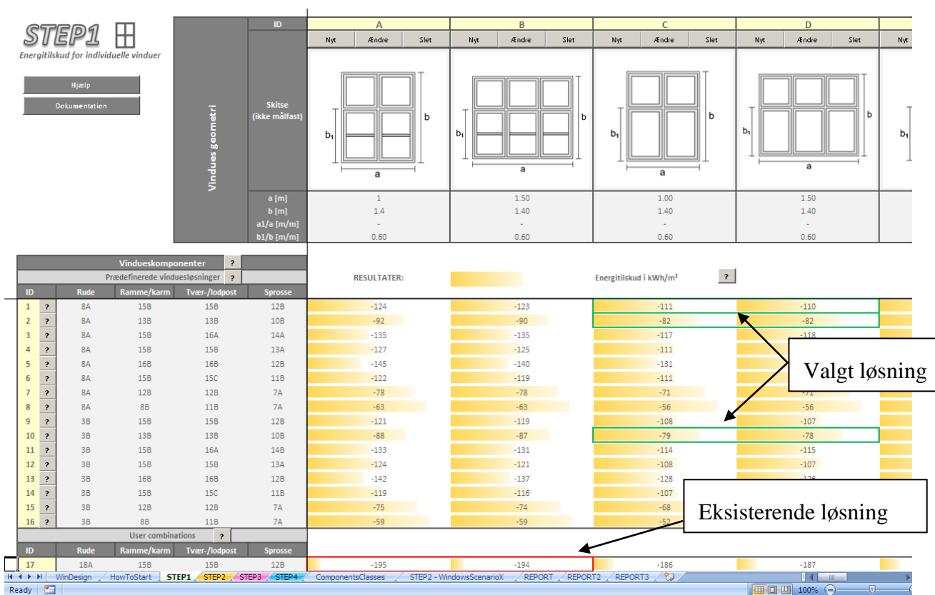
Figur 9 Screenshot efter indtastning af gamle (Type A og B) og nye (C og D) vinduer i STEP1
