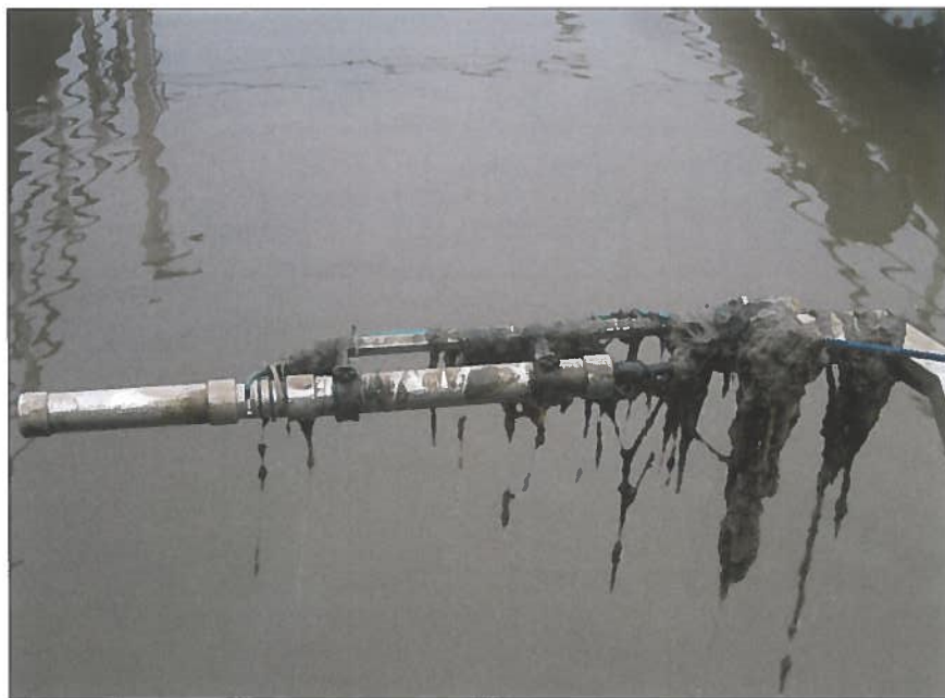
Figur 1. Så beskidt kan en sensor være, når den har været neddykket i spildevandsstrømmen. Her er sensoren opsat på en vippearms, så den let kan rengøres. Foto: Ravi Chhetri.
