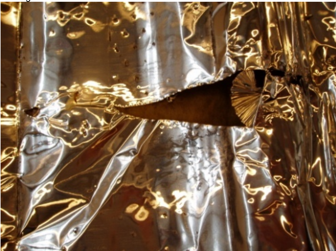
Figur 37. Sprække i den reflekterende folie i solfangeren fra Marstal.
