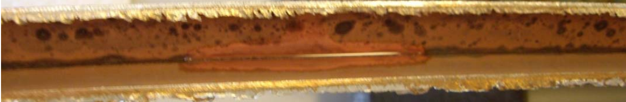
Figur 25. Øvre del af opskåret 7. sunstrip talt for oven af i midten af solfangeren.
