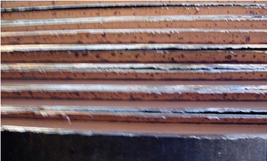
Figur 36. Opskårne sunstrips i nederste del af solfangerens midte.
