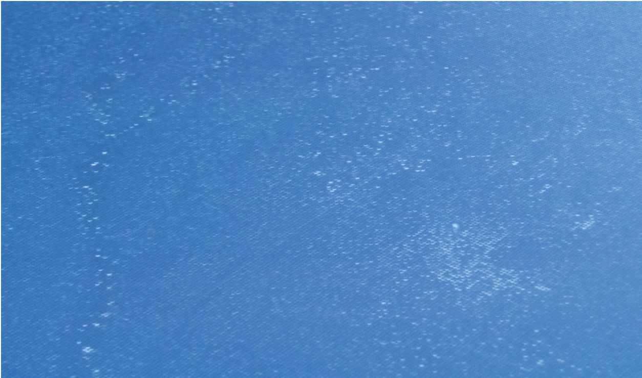
Figur 27. Hvide belægninger på indersiden af glas for solfangeren fra Marstal.
