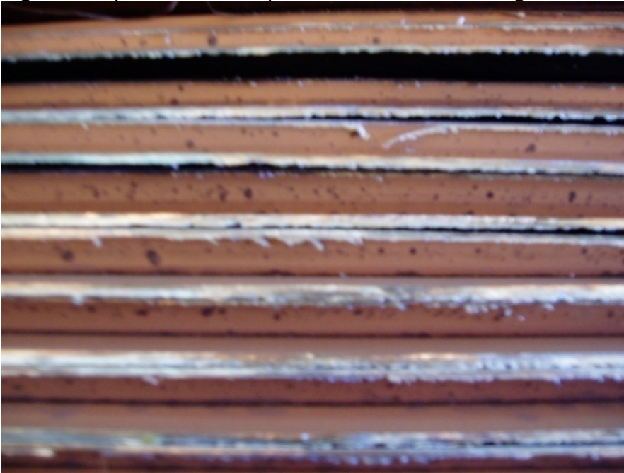
Figur 35. Opskårne sunstrips i midterste del af solfangeren midte.
