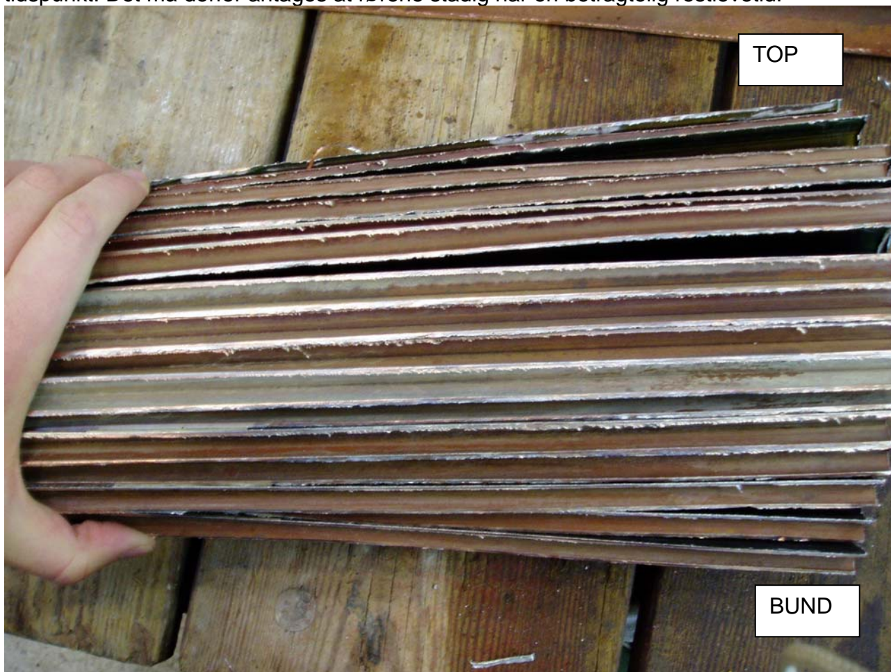
Figur 24. Undersiden af 16 opskårne sunstrips med belægninger i de midterste strips.
