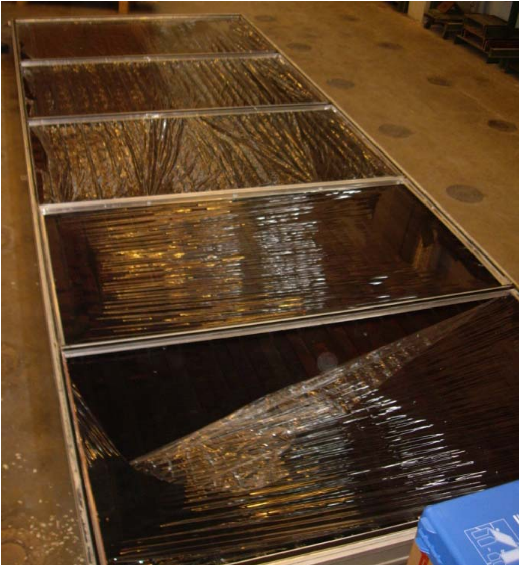
Figur 21. Teflonfoliens opspænding i solfangeren fra Ottrupgård.
