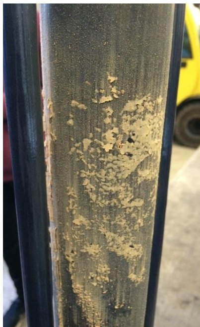
Figur 66 Kalkaflejringer på varmelegemet samt åbningen til pexrøret.
