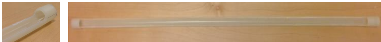
Figur 37 PEX rør, udsparet.
