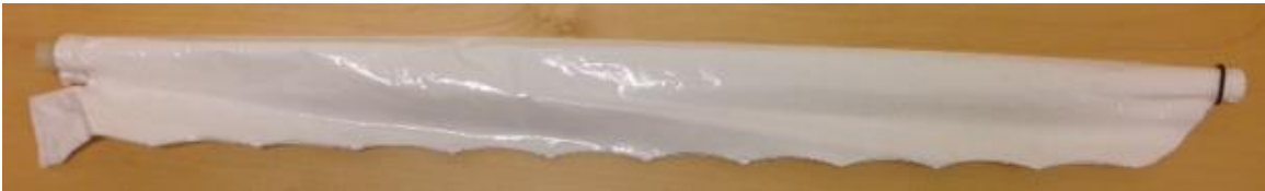
Figur 40 Stratifier 3, PEX rør, opboret med polymerfilm
