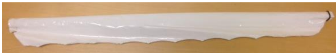
Figur 38 Stratifier 2 - PEX rør, udsparet med polymerfilm
