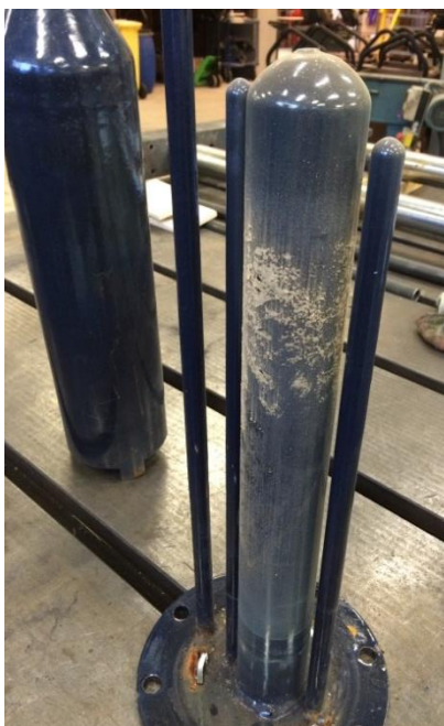
Figur 66 Kalkaflejringer på varmelegemet samt åbningen til pexrøret.
