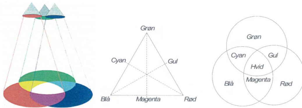
Figur 11-8 Hjernes farvemæssige fortolkning af tappens signaler - Addition af farver; Kilde: P. E. Petersen – Lys og varme
