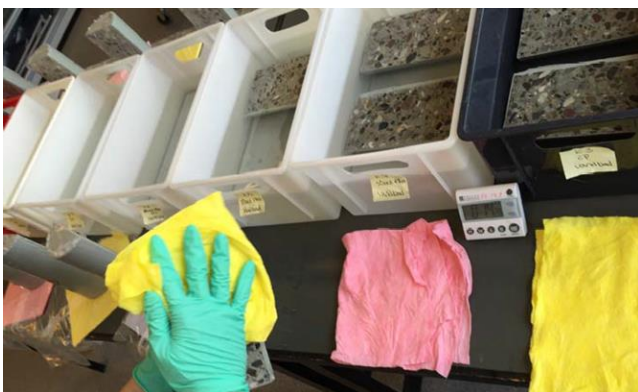
Figur 12. Forsøgsopstilling for prøveemner nedsænket i en 3 % -NaCl-opløsning. Prøveemnerne er placeret i NaCl-opløsning med ca. 3 cm frit vand over. Emnerne er kassevis inddelt iht. tidtagning og opmærkning. Ligeledes har hvert prøveemne sin egen klud, som bruges til at fjerne frit vand på emnets overflade umiddelbart efter optagelse og vejning, hvorpå de atter placeres i NaCl-opløsningen.
