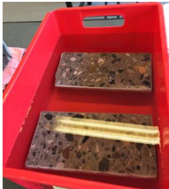
Figur 14. Forsøgsopstilling. Til venstre ses prøveemner der har 15 minutters hvileperiode i hvilken de vejes. Til højre ses prøveemner der eksponeres i 15 minutter, hvorefter de tages op og vejes. Proceduren er som følger: 3 gange eksponering af 15 minutter per gang med 15 minutter hvile mellem eksponeringer.
