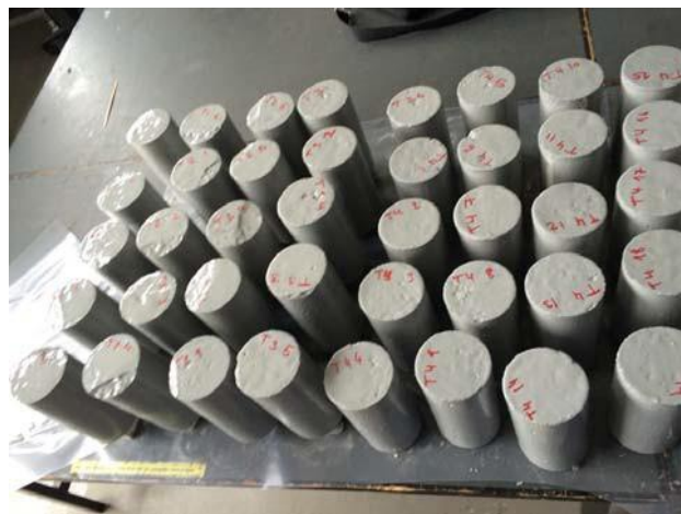
Figur 7 Laboratorie. Epoxy forsegling. Prøverne er anbragt på små understøtninger på et plastik underlag med deres individuelle nummerering. Prøveemnerne placeres med tilstrækkelig mellemrum for at sikre friluftcirkulation under behandlingen.
