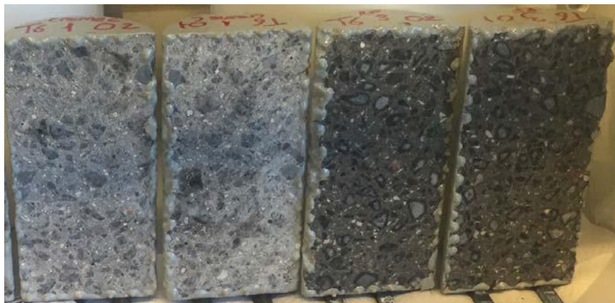
Figur 8. Forsøgsopstilling. Prøverne er anbragt opretstående på messingunderstøtninger på et plastikunderlag. De lodrette skæreflader blev herefter imprægneret. De to prøver til højre er netop blevet imprægneret for første gang, mens de to prøver til venstre venter på at få anden behandling (vådt i vådt).
