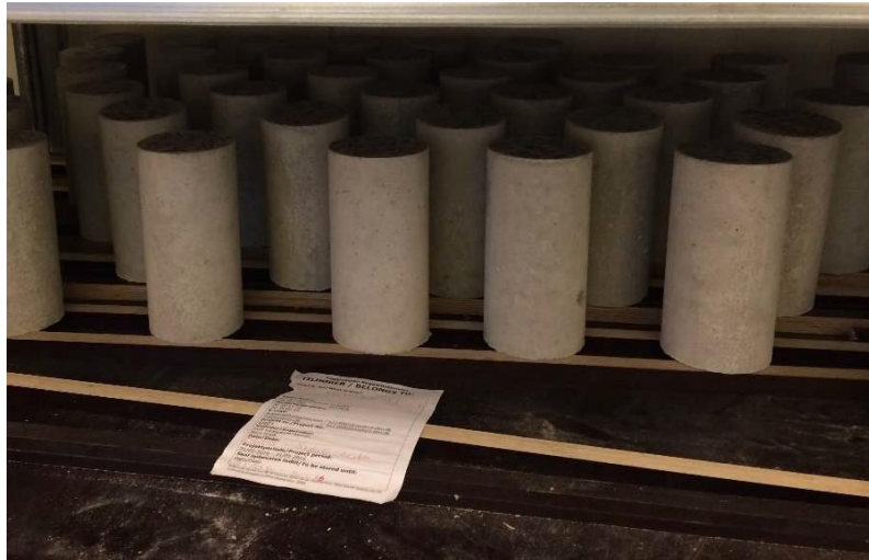
Figur 6. Klimakammer. Prøverne er anbragt opretstående på trælisteunderstøtninger med tilstrækkeligt mellemrum for at sikre friluftcirkulation.
