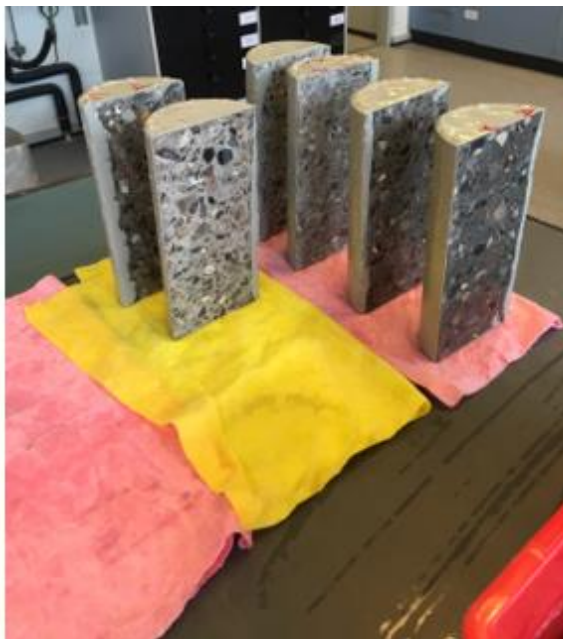
Figur 14. Forsøgsopstilling. Til venstre ses prøveemner der har 15 minutters hvileperiode i hvilken de vejes. Til højre ses prøveemner der eksponeres i 15 minutter, hvorefter de tages op og vejes. Proceduren er som følger: 3 gange eksponering af 15 minutter per gang med 15 minutter hvile mellem eksponeringer.
