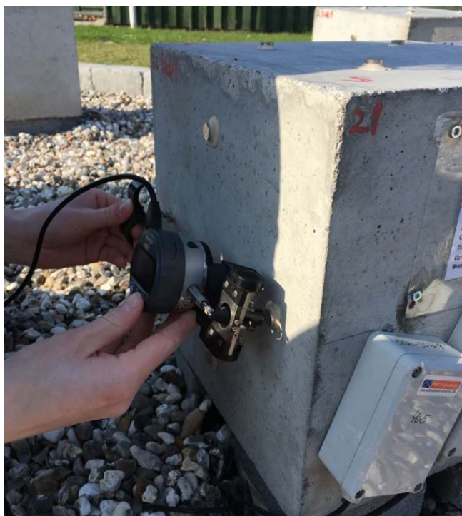
Figur 7: Ekspansionsmålinger bliver foretaget på eksponeringsarealet.
