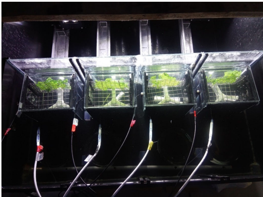
Figur 5.1. Opstilling for måling af fotosyntese respons hos makroalgers thallusstykker.
