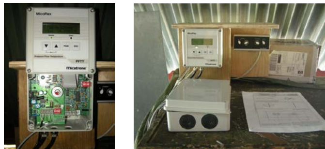
Figur 13. Micatrone microprocessor, MF-PFTT (venstre) og måleopstillingen (højre).
