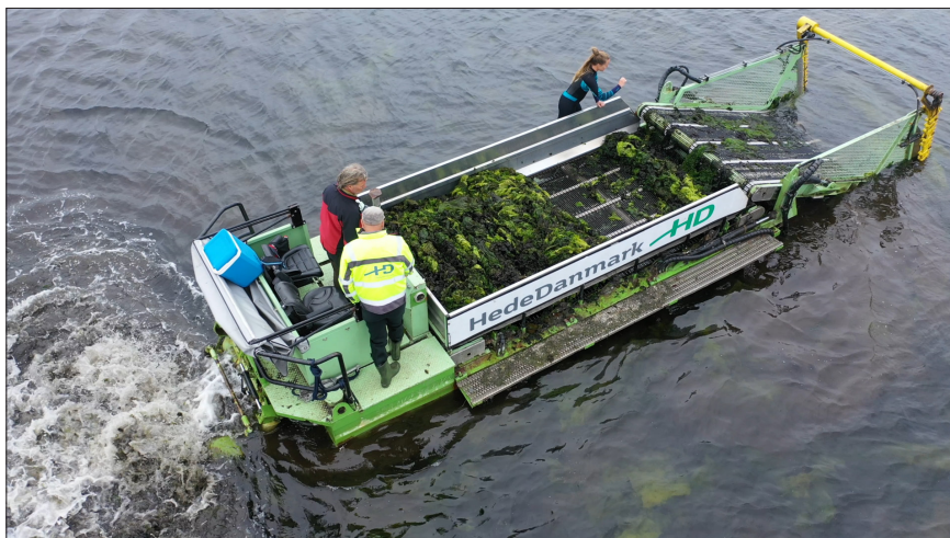
Figur 7. Forsøgshøst af søsalat i Skive Fjord med en maskine, der til dagligt bruges til høst af grøde i søer (foto: Michael Bo Rasmussen).
