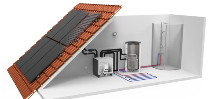
Figure 1 – Complete PVT energy system from Nærvarmeværket.
