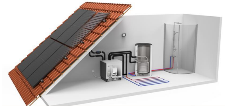
Figure 6. Complete PVT energy system from Nærværmærket.
