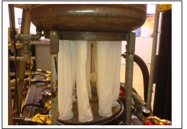
Figur 26. Billeder af tanke og stratifikationsindløbsrør under installationen på DTU BYG.
