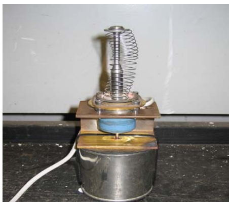
Figur 18. Opstilling til afprøvning af magnetdrevet stempel til aktivering af krystaldannelsen i et underafkølet salthydrat.
