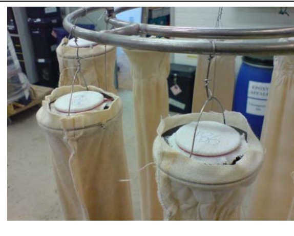
Figur 26. Billeder af tanke og stratifikationsindløbsrør under installationen på DTU BYG.
