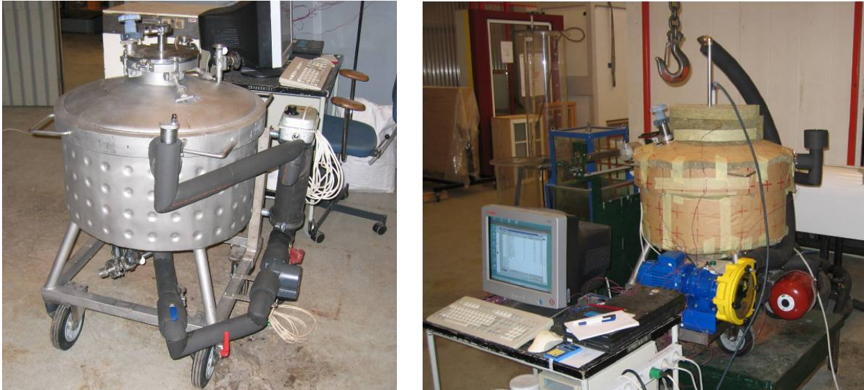
Figur 9. Venstre: Smeltebeholder med monteret varmelegeme til opvarmning af kappen. Højre: Smeltebeholder isoleret og monteret med slangepumpe (gul) til cirkulation af smeltet salthydrat.
