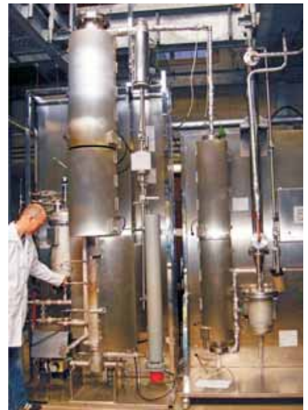
Forsøgsanlæg på University of Limerick i Irland, der kan bruges til forgasning og pyrolyse .
