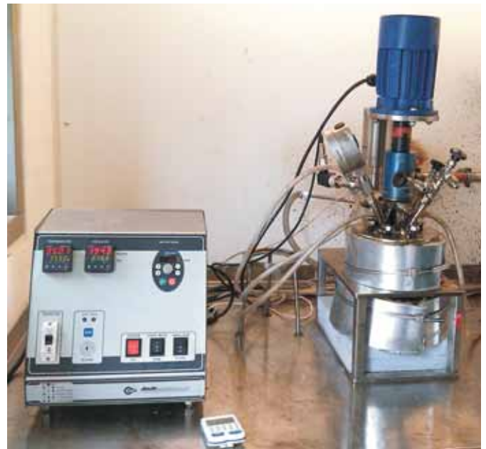
HTL-anlægget på Aalborg Universitet, hvor biomasse i løbet af cirka 15 minutter kan omdannes til olie.
