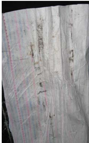
Figur 40: Eksempel på farvemærkning på C3, hvor NAPL membranen er blevet "gennemsigtig".
