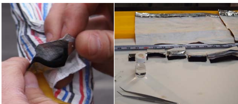
Figur 4: Aktiv kulstof filt påsyet bagsiden af den hydrofobe membran og beskyttet af diffusionsbarriere i aluminium (venstre) og prøvetagning af aktiv kulstof filt (højre)
