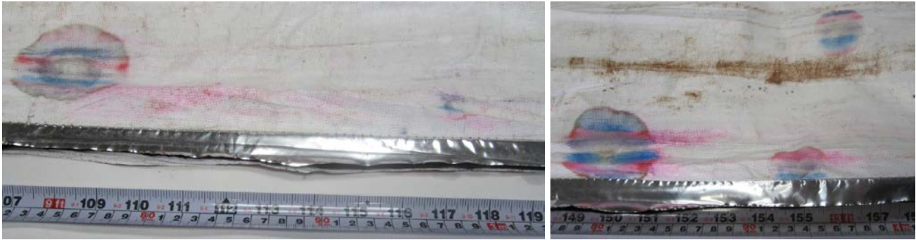
Figur 29: Eksempler på farvemarkeringer på NAPL membran fra CTF2. Til venstre ses tydelig plet ved 2,70-2,78 m u.t. og utydelig farvemarkering ved 2,96-3,00 m u.t. Til højre ses en plet ved 3,78-3,85, og to pletter ved 3,91-3,99 m u.t.
