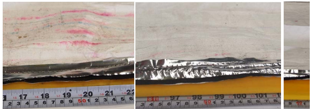
Figur 30: Farvemarkeringer på NAPL membran fra CTF3. Venstre: rødlige striber ved 0,36-0,59 m u.t. Midt: eksempel på meget svage farvemarkeringer ved 2,44-2,53 m u.t. Højre: Lille rød prik ved 4,40 m u.t.
