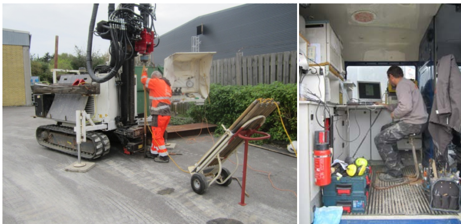
Figur 6: MIP sondering (venstre) og feltlaboratorium med FID og ECD detektorer samt GC-MS til analyse for forureningsstoffer (højre).
