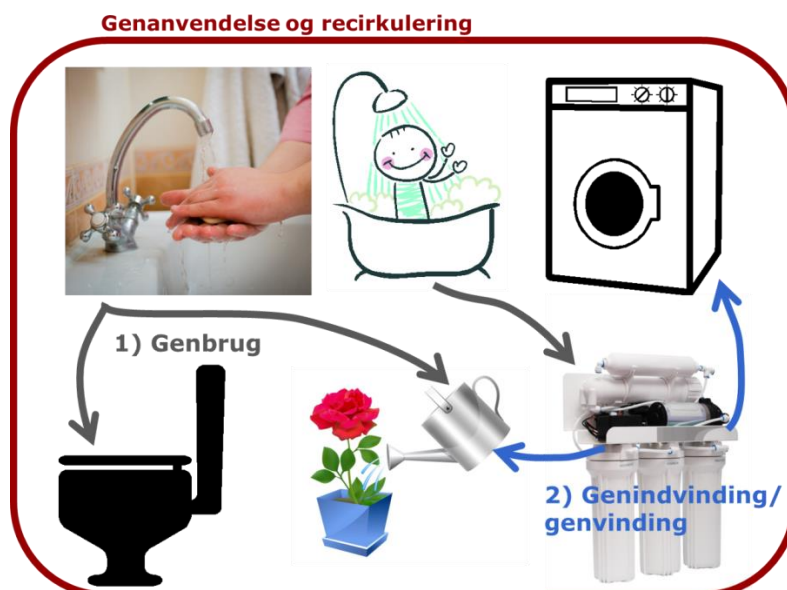
Figur 2. Eksempel på anvendelse af termerne for genanvendelse og recirkulering , hvor der skelnes mellem 1) genbrug uden oprensning og 2) genindvinding/genvinding ved hjælp af renseteknologi.
