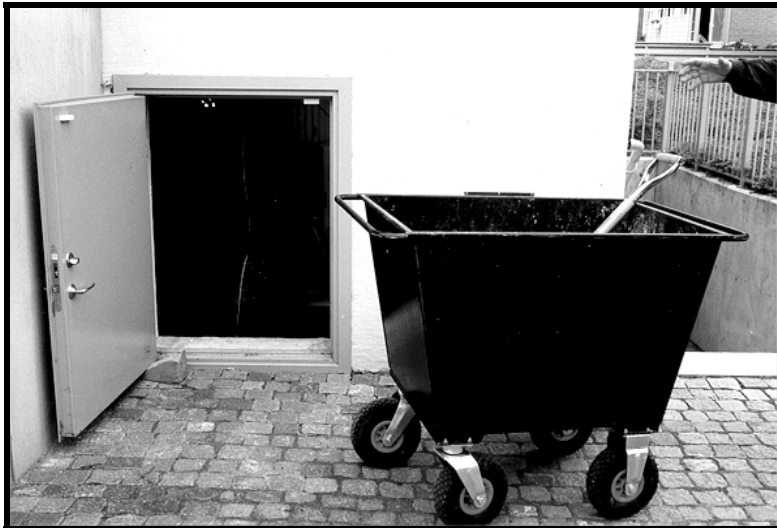
Komposten fra tromlem føres med snegl til denne åbne vogn, der hejses op gennem lugen og komposten kan køres til efterkompostering
