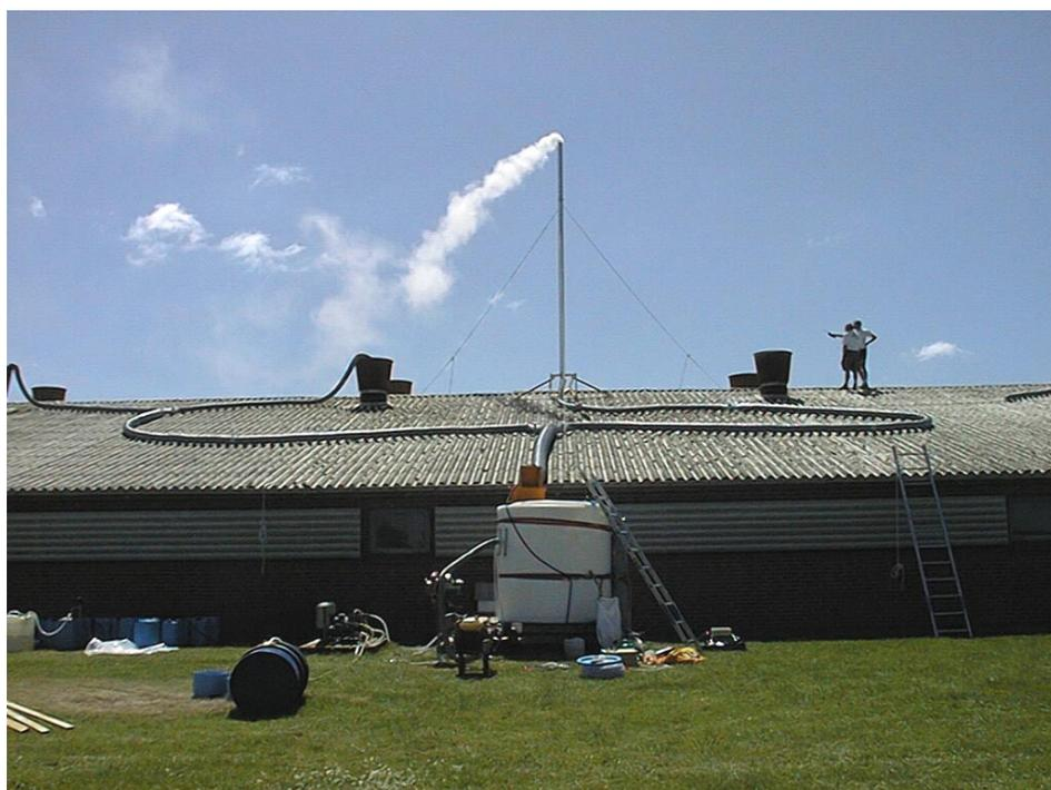
*Figur 2-1 viser Røgmaskinen tilsluttet et forhøjet afkast (+ 6 meter over kip). Den store hvide beholder er blandingstanken hvor syre og basevæskerne sprayes sammen via en luftdysse, og danner aerosol "røg", som så pumpes ud til dyserne gennem slangerne på taget. Røgslangerne på taget er fleksible, og kan derfor trækkes hen til de respektive udluftninger som skal have tilsat røg.*
