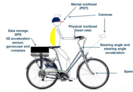
Figur 1: Skematisk gengivelse af den cykeltype og det udstyr der blev benyttet i forbindelse med undersøgelsen.
