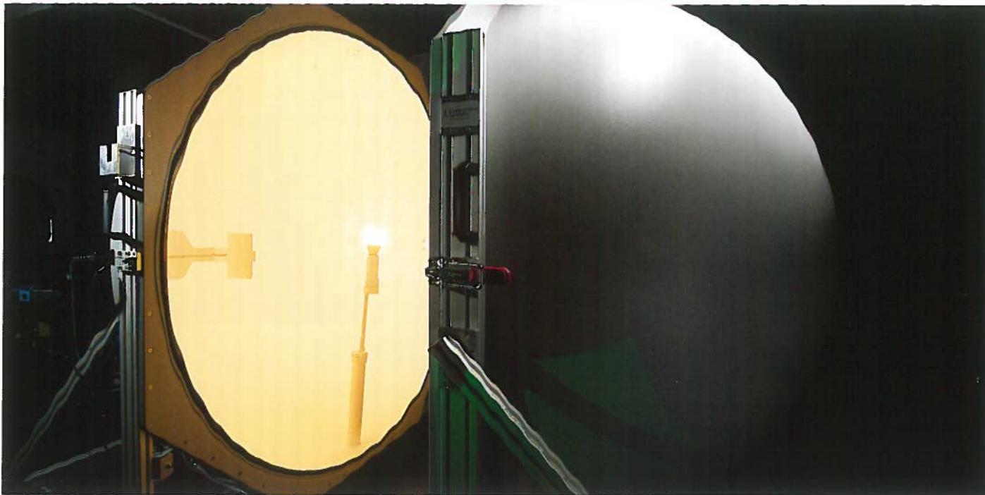
Måling af en LED-pære i den integrerende kugle (2 meter i diameter) i det fotometriske laboratorium hos DTU Fotonik/DOLL.
