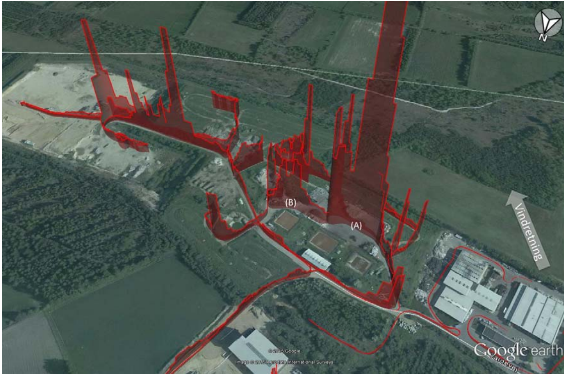
Figur 5. Screening af metankoncentrationer – den centrale del af deponiet. Den røde kurve illustrerer målte koncentrationer af metan over baggrundsniveau (1,943 ppm), og er ganget med 200 for at være synlig på kortet.
