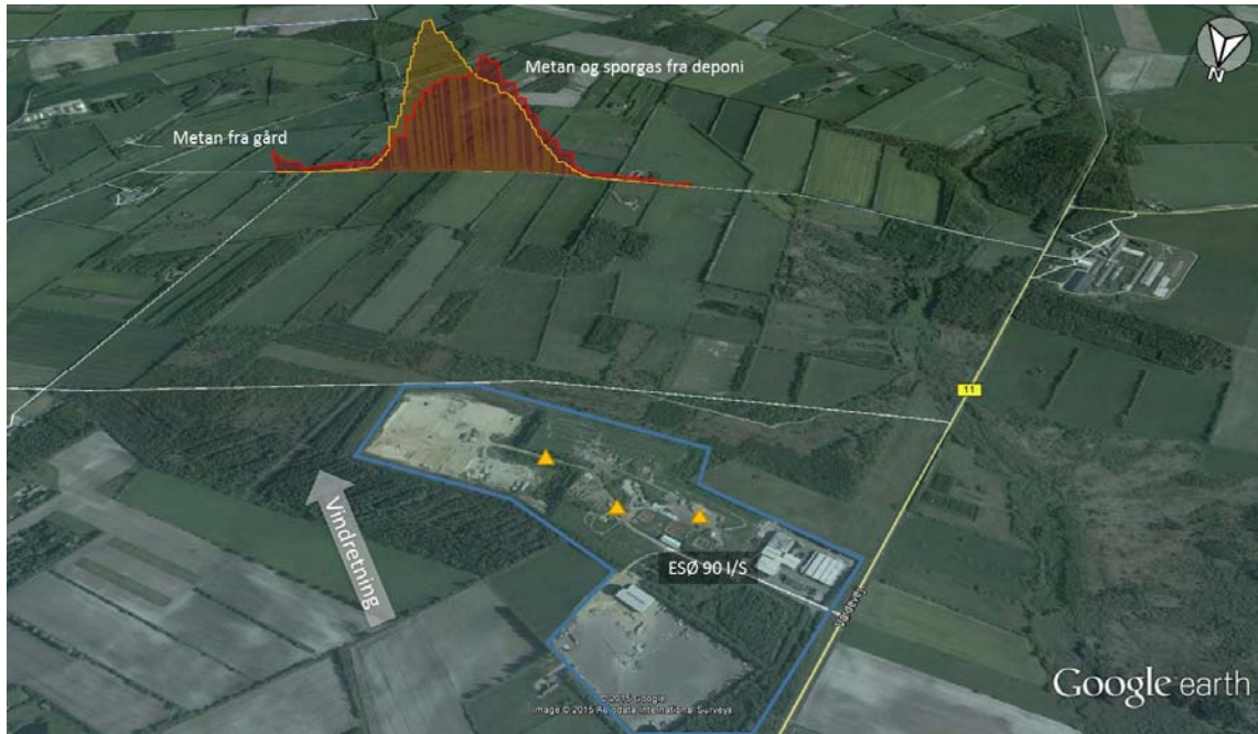
Figur 6. Eksempel på måling af metan og sporgaskoncentrationer nedvindt for deponiet (udført kl. 22:04). Den røde kurve illustrerer målte koncentrationer af metan over baggrunds niveau (1,955 ppm) og er ganget med 6000 for at være synlig på kortet. Den gule kurve illustrerer målte koncentrationer af sporgas (acetylen) og er ganget med 15. De gule trekantede markerer, hvor der blev frigivet sporstof.
