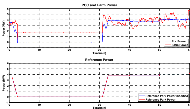
Fig. 14. Potenza del parco (rossa) e potenza al PCC (blu); potenza di riferimento a 10 minuti (rossa).
