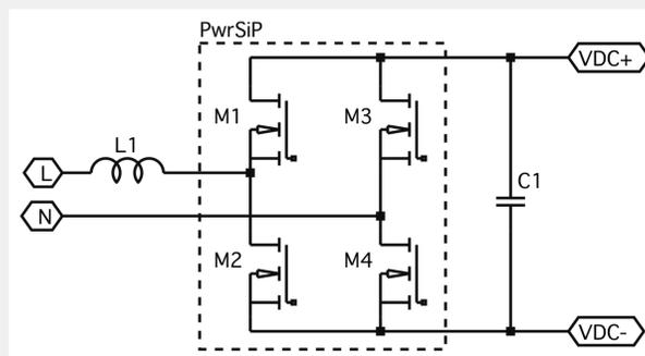
Figure 1. Bridgeless Totem Pole Rectifier
