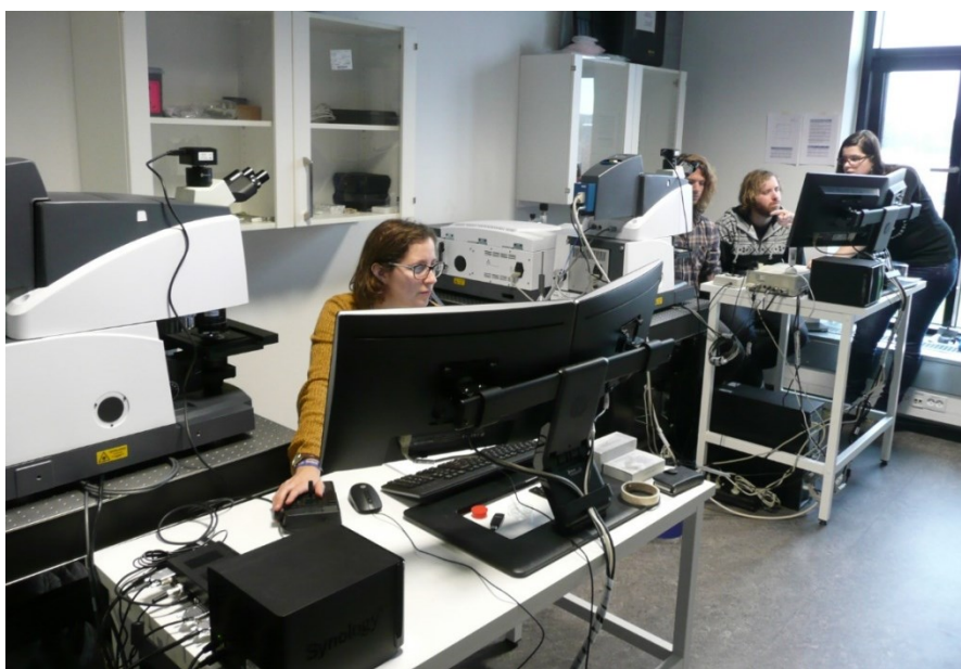
Figur 9. \mu\text{FTIR} imaging udstyr anvendt til mikroplast partikler <500 \mu\text{m} .
