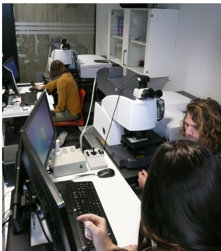
Figur 44. AAUs to Agilent Cary 620 FT-IR-mikroskoper hvert med 128x128 pixel FPA koblet til Agilent Cary 670 IR spektroskoper.
