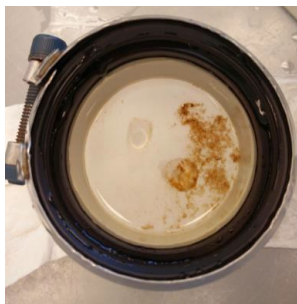
Figur 31. 20 µm membranfilter efter filtrering af udløbsvand fra Renseanlæg A . Der ses en forekomst af alger på filtret, som vurderes at påvirke tilbageholdelsen af 20 µm PS partikler.
