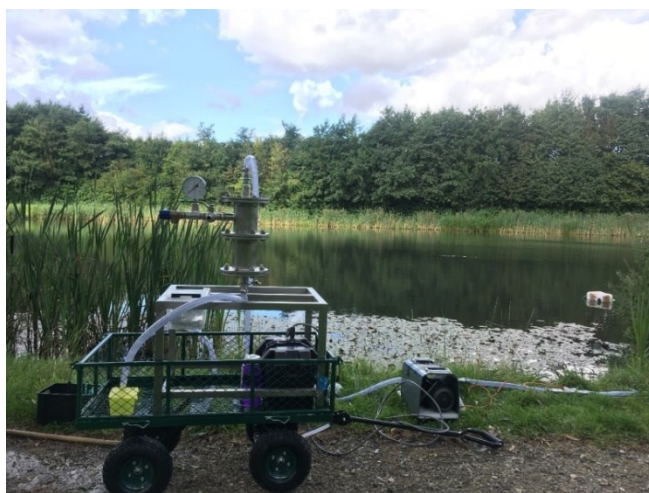
Figur 38. Udstyr til udtagning af vandprøver fra regnvandsbassiner.
