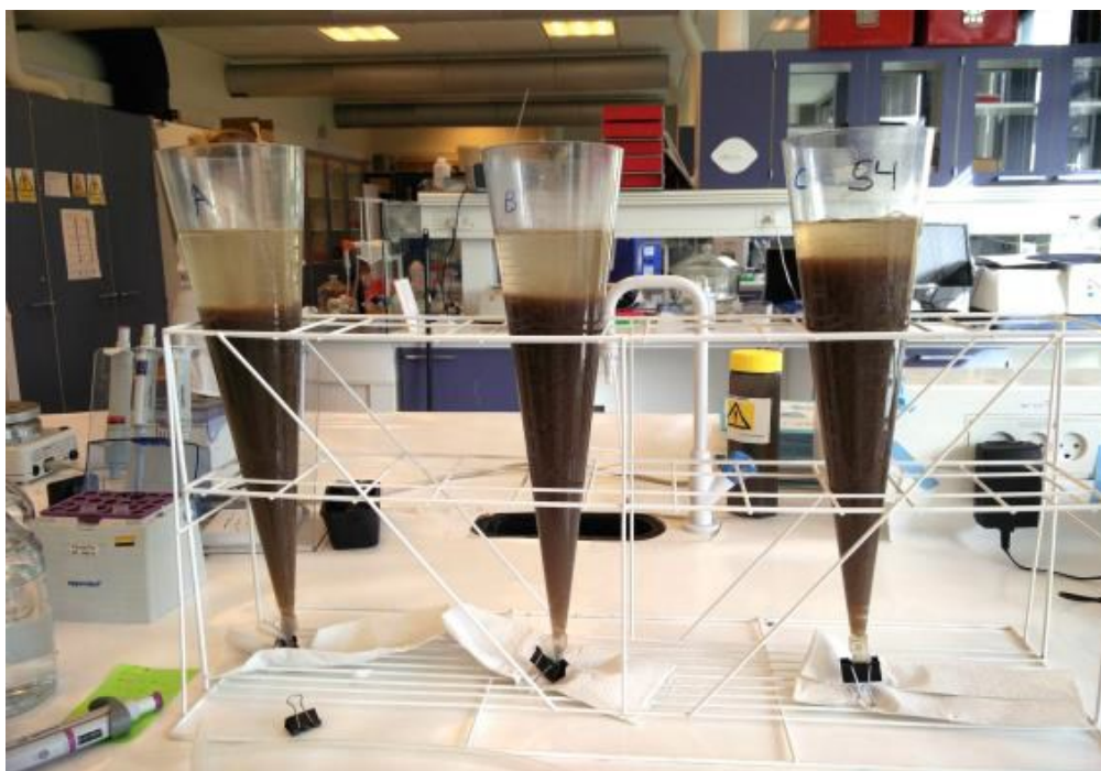
Figur 27. Forsøgsopsætning for lab-skala simulering af primær og sekundær klaringskank.
