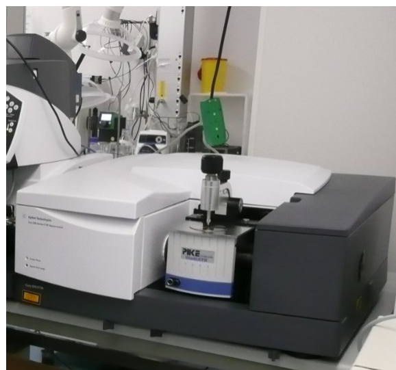
Figur 43. ATR-FT-IR til analyse af større mikroplast partikler (>300-500 \mu m).
