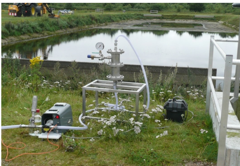
Figur 7. Filtersystemet anvendt ved prøvetagning på Renseanlæg B.
