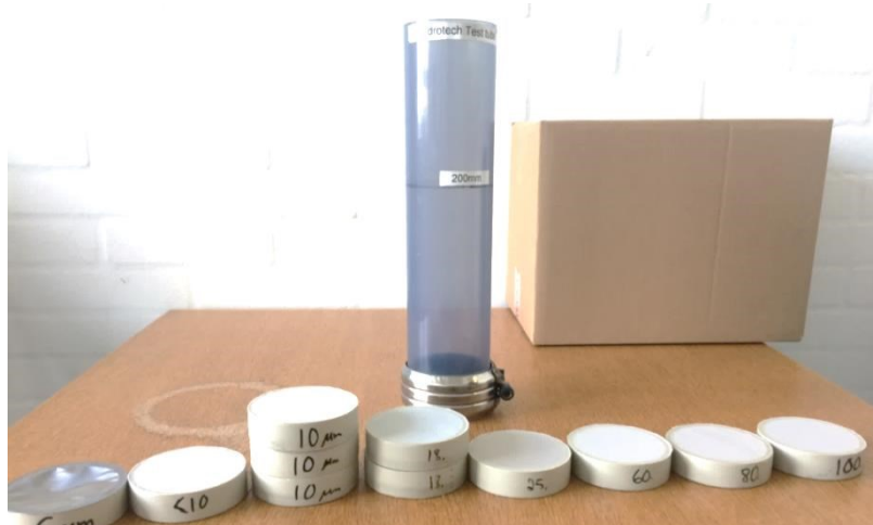
Figur 29. Hydrotech udstyr til test af membranfiltre.
