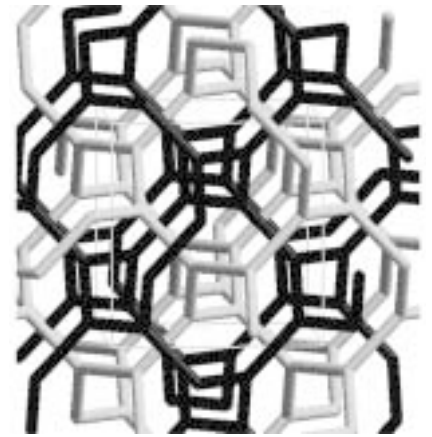
Figur 3b. »Gyroid«-morfologien set ned langs [100]-retningen. Den kubiske enhedscelle kan anes og er markeret i lys grå.
