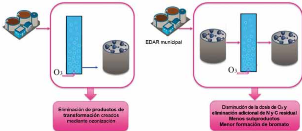
FIGURA 5. Depuración de aguas residuales de efluentes municipales con eXenO 3 .
