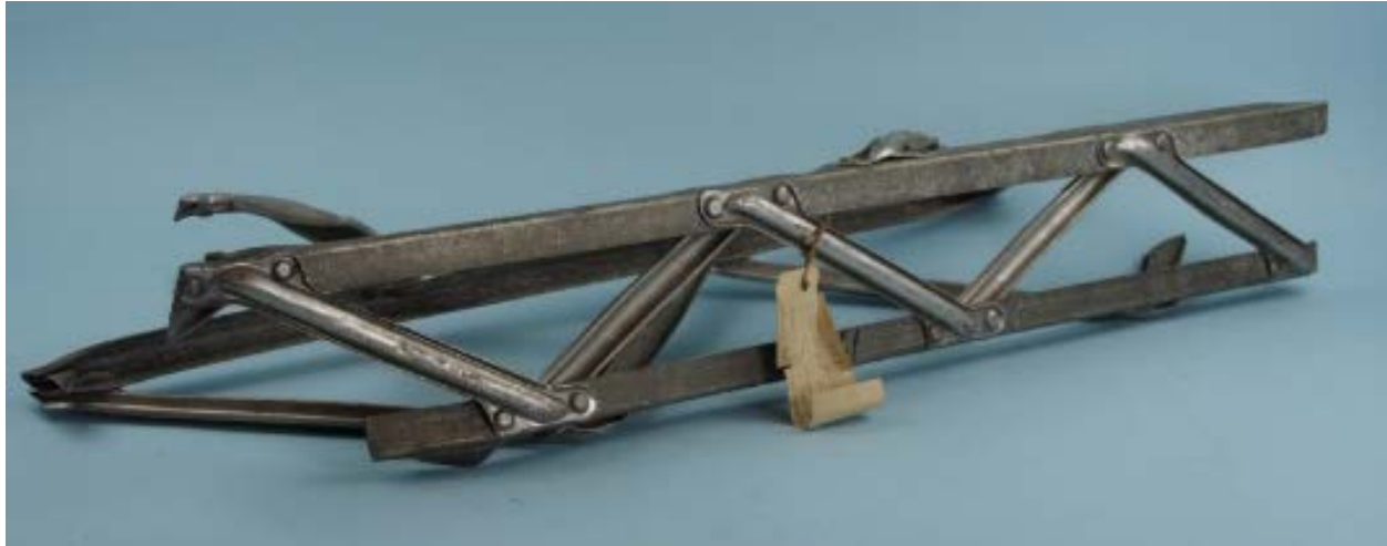
I 1915 nødlandede det tyske luftskib L3 på Fanø. For at beskytte datidens højteknologi skød besætningen luftskibet i brand efter landingen. Denne rest er bevaret på DTU. Diagonalerne er af rent aluminium, mens resten er af en stærkere legering af aluminium, kobber og zink.
