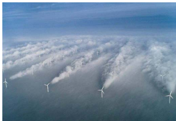
Skyggeeffekter af Horns Rev 1 havvindmøllepark i Nordsøen. Kilde: Vattenfall.
