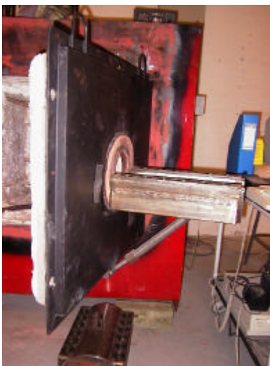
Figur 2.1. Foto af ny ovnlåge med nedre stålkappe
