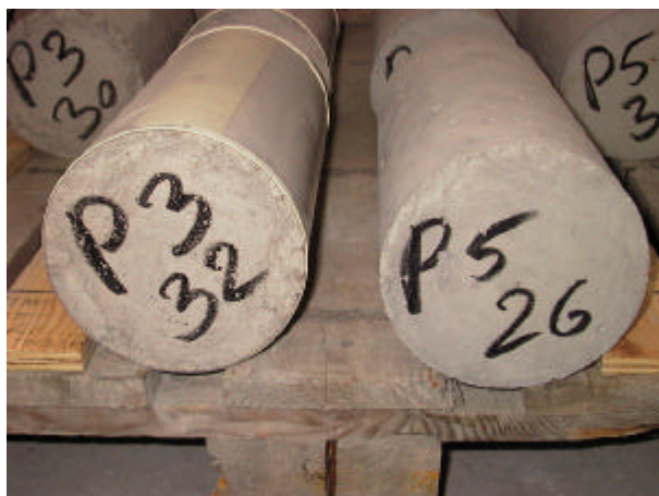
Figur 4.2. Foto af cylindre under udtørring i forsøgshal. P3 med forsegling på krum flade og P5 uden forsegling.
