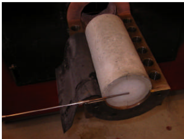
Figur 5.17. Foto af betoncylinder efter prøvning for eksplosiv afskalning. Bemærk at betonen er blevet lysere på det eksponerede område.
