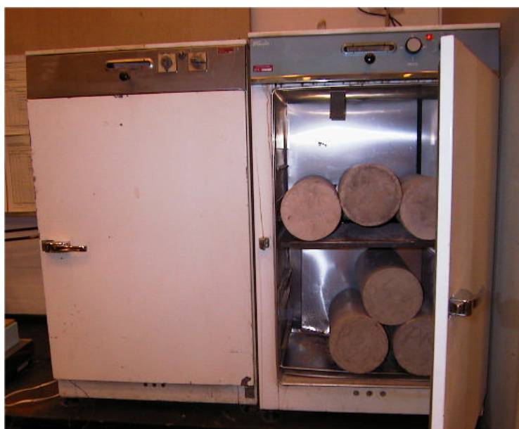
Figur 3.11 Foto af lukket tørreovn t.v. og åben tørreovn med betoncylindre th.
