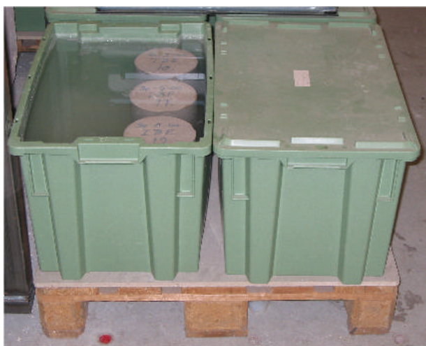
Figur 3.1 Foto af vandkar med 3 cylindre tv. og vandkar med låg th.
