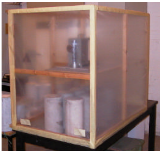
Figur 3.1. Foto af klimakammer med betoncylindre for neden og hygrometer på hylde.
