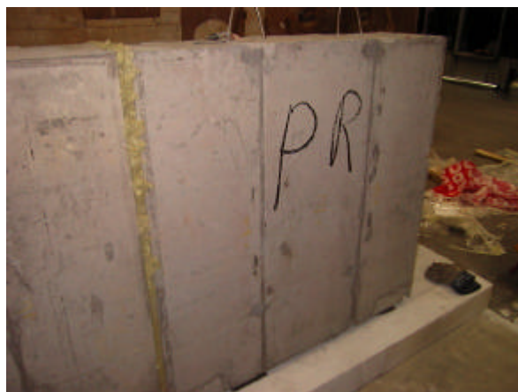
Figur 4.10. Foto af vægelement af beton PR og P3. Desuden ses isoleringen mellem de to vægelementer.
