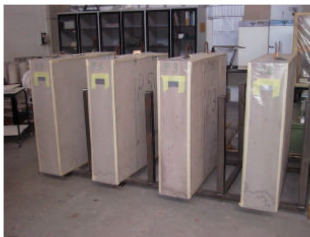
Figur 4.5. Vægelementer med forsegling med gennemsigtig plast på korte sider.
