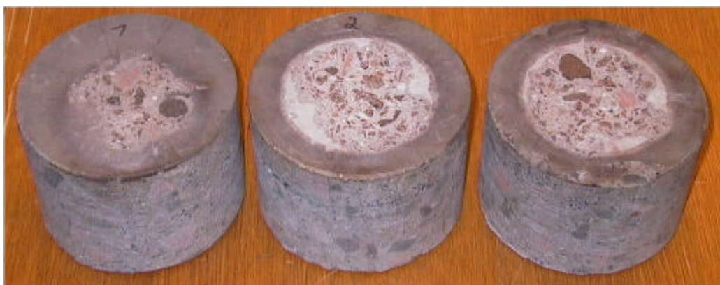
Figur 2.16. Foto af de 3 afprøvede borekærner Ø 143 mm x 100 mm fra flise nr. 9.
