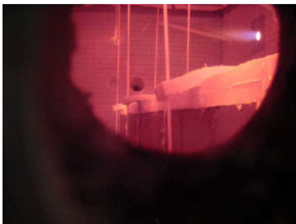
Figur 4.11. Foto af vægelementer under brandprøvning. Foto taget gennem skueglas.
