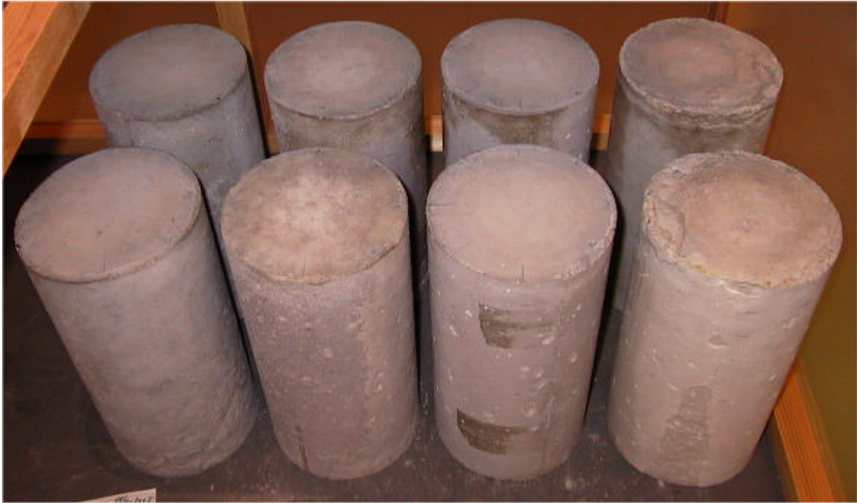
Figur 4.22. Foto af de brandprøvede betoncylindre. I første venstre søjle ses 2 cylindre med betontype PR dernæst P3, P5 og P7.
