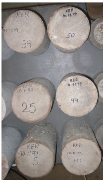
Figur 2.13. Foto af de 6 testede KER 10.11.99 betoncylindre.
