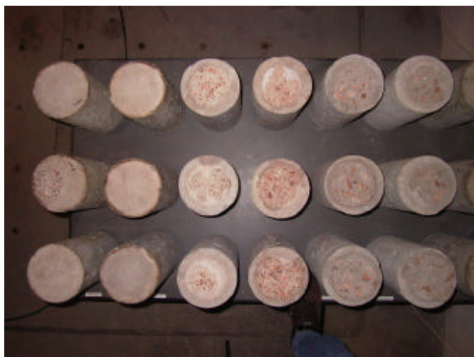
Figur 3.3. Foto af de afprøvede betoncylindre med A-betoner. I første venstre søjle ses 3 cylindre med betontype AR dernæst A0, A1, A3, A5 og A6.
