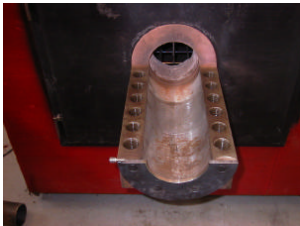
Figur 5.5. Foto af stor ovn med ovnlåge og fastmonteret underdel af stålkappe.
