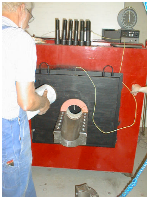
Figur 2.7. Foto ved montering af betoncylinder i underdel af stålcape.
