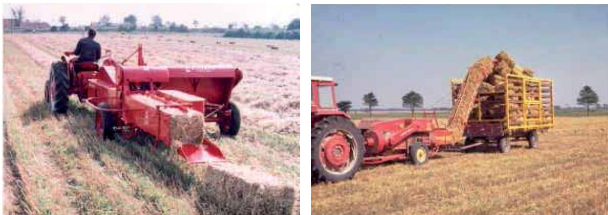
Figure 2.8. Équipement léger pour la production de petites balles de 12 kg (Nielsen 2003)
