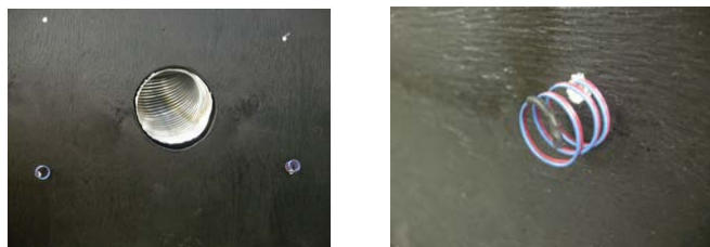
Figur 7. Fotos af termoelementerne på forsiden af toppladen, hvor de yderste 20 cm af termoelementer er viklet i en spiral.
