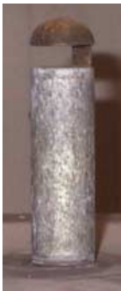
Figur 3-21: Billede af indløbsdesignet i varmtvandsbeholderen.
