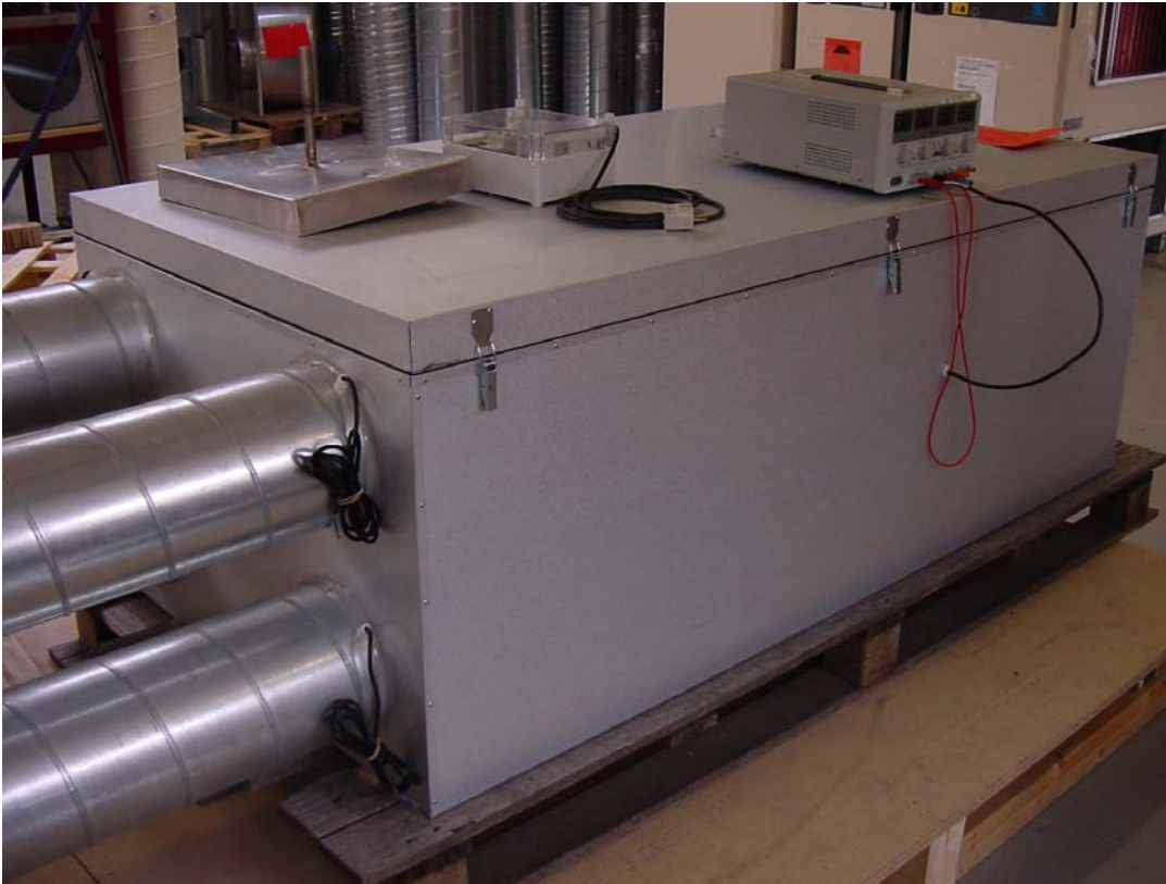
Figur 6 Billede af varmegenvindingsenheden til lavenergihuset i Sisimiut
