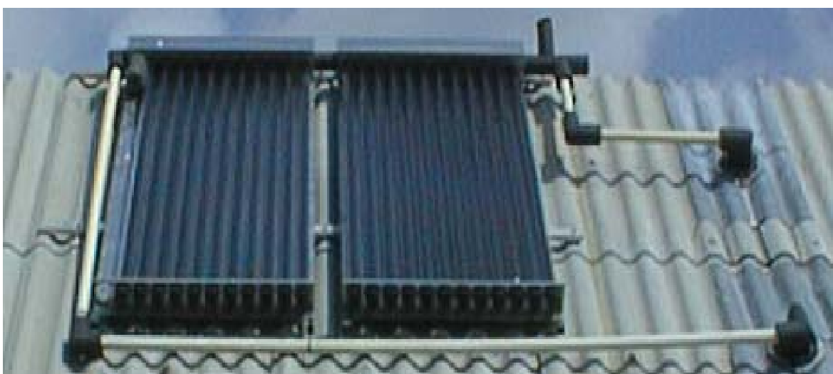
Figur 6 Billede af to SLU-1500/12 installeret i instituttets forsøgsopstilling.
