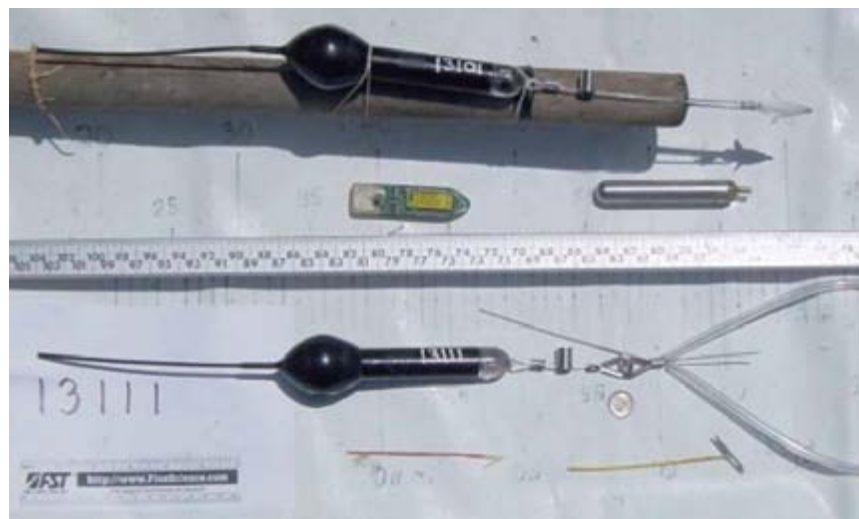
Et pop-up satellit-arkivmærke på en mærknings-pæl, to små arkivmærker nedenunder, et pop-up satellit arkivmærke på en plasticisoleret stålwire og nederst to gammeldags (ikke elektroniske) spaghettimærker.
