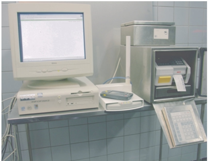
Figur 2. Udstyret i projektet. Hvert enkelt led i kæden har en stor PC, en strekkodescanner der fungerer via trådløst netværk, et vandtæt tastatur og en printer i en kasse der skal beskytte den mod det våde miljø.
