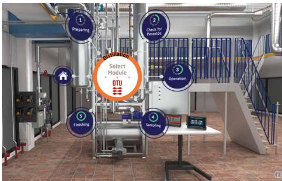
Figur 2. Skærmbillede fra Pilot Plant VR-miljøet til Destillation i Bubble-Cap Tray Column-enhedsdrift.
