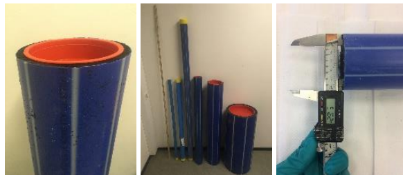
Figur 3: Uponor plastrør af PE, stykker i forskellige dimensioner 32-320 DN (mm).
