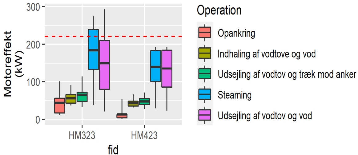
Figur 8. Boxplot, der viser hvor meget motoreffekt (kW) de to fartøjer bruger i de forskellige fiskeoperationer. Kassens øvre og nedre grænse viser øvre og nedre kvartil, og kassen indeholder således halvdelen af de observerede værdier. Stregen i midten viser medianen. Kassen er suppleret med "haler", der viser 5-95% konfidensintervallet. Den stiplede røde streg viser 221 kW grænsen.
