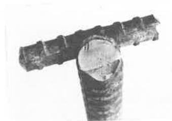
Figur H1, Foto af udmattelsesbrud i Ø 10 mm kamstål
