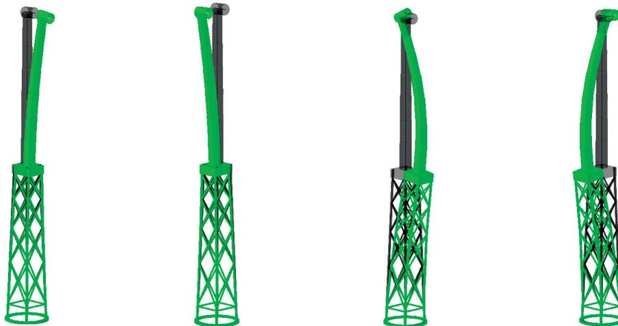
Fig. 2. (a) 1<sup>st</sup> Fore-Aft Mode; (b) 1<sup>st</sup> Side-Side Mode; (c) 2<sup>nd</sup> Fore-Aft Mode; (d) 2<sup>nd</sup> Side-Side Mode. Eigenmodes of the jacket structures modelled with Abaqus.
