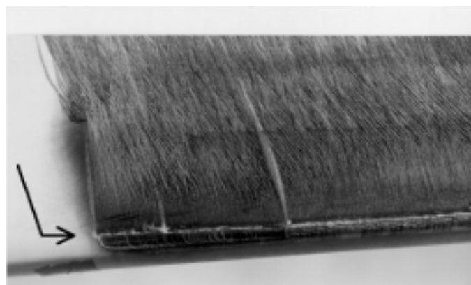
Figur 3-9 'Oil flow' visualisering på en roterende vinge.
