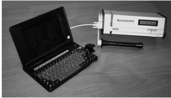
Figur 5. De kontinuerte radonmonitører tømmes for data vha. en bærbar pc'er. Radonmonitoren har et display, som løbende viser rummets radonkoncentration samt temperatur- og trykforhold.
