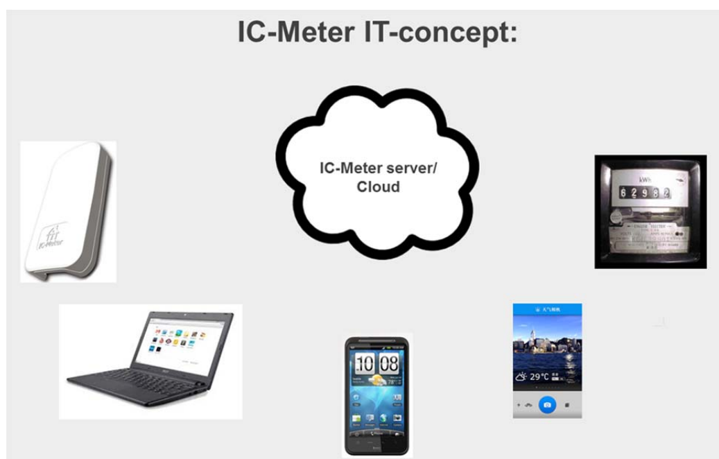
Figur 6: IC-Meters informationsarkitektur. Data fra indeklimate og energimåler samt vejrtjenester analyseres, og resultaterne formidles til PC/smartphone og gemmes samtidig i boligens ”black box”.
