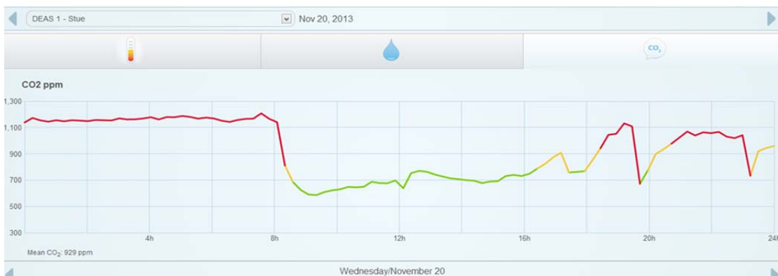
Figur 10: CO 2 -indhold i en lejlighed. CO 2 -indholdet måles hvert 5. minut. I grafen vises den tilhørende aktuelle smiley-farve. Det meget markante fald i CO 2 -indhold skyldes aktiv udluftning. Hvis boligen forlades med lukkede døre og vinduer falder CO 2 -indholdet derimod langsomt svarende til boligens tæthed.
