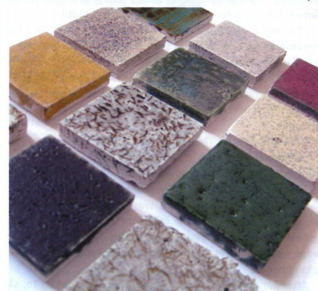
Prøver på keramisk glaseret beton. Mulighederne for nye udtryk er nærmest uendelige.
